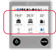
Kuva 10b. Tilanäytön päävalikot, 2-vyöhykejärjestelmä
