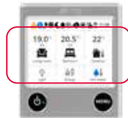
Slika 10b. Glavni meniji na zaslону stanja, dvoconski sistem
