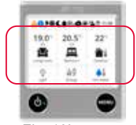
Fig. 10b. Menús principales en la pantalla de estado, sistema de 2 zonas
